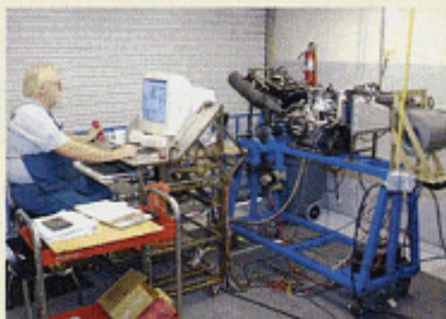
que em conjunto com um completo sistema de aquisição de dados pode testar motores a dois ou quatro tempos com potências na ordem dos 200 cavalos.
